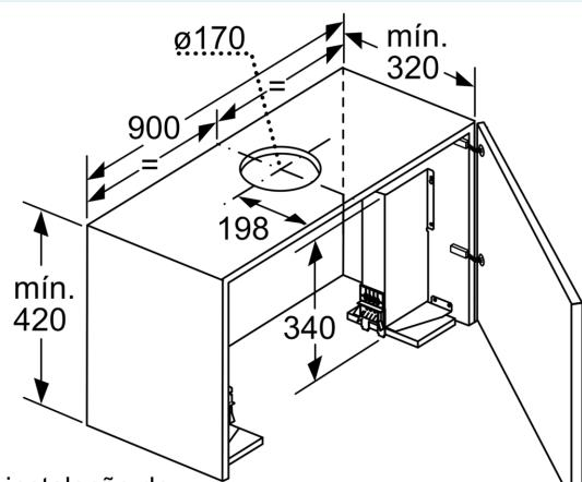
Na instalação do exaustor com painel plano de 90 cm num armário superior com 90 cm de largura é necessário um kit de instalação. Os dois suportes de instalação são aparafusados no móvel, à direita e à esquerda. Instalação de acordo com a matriz. Medidas em mm
